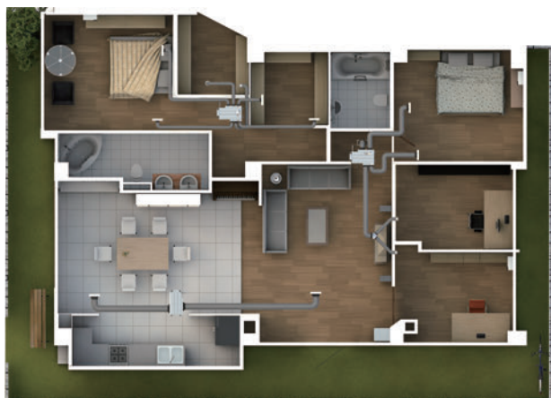
▲風管搭配運用，(1-1)，(1-2)，(1-3)
